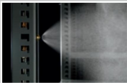
Der Sprühnebel besteht aus einer Vielzahl kleinster Tröpfchen mit Durchmessern unterhalb von 50 µm
